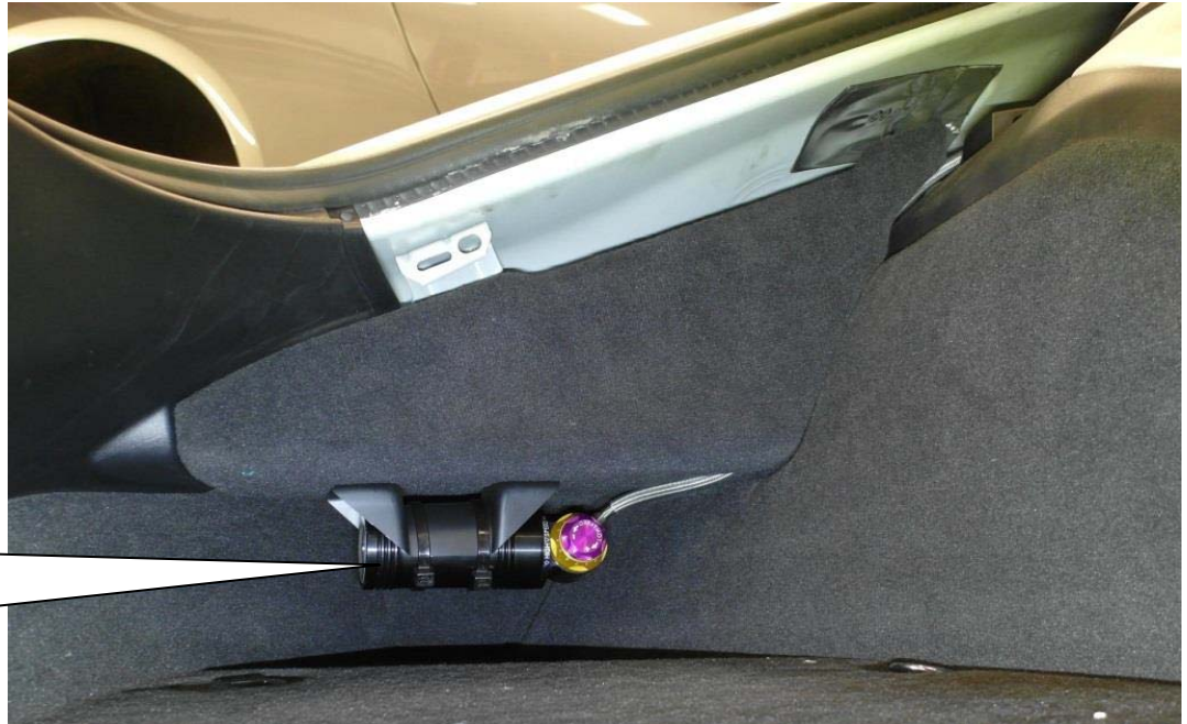
Ausgleichsbehälter mit Kabelbinder am Halter befestigen
