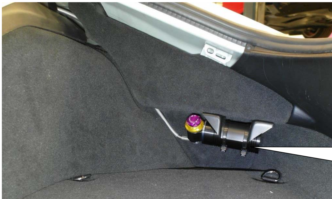
Ausgleichsbehälter mit Kabelbinder am Halter befestigen
